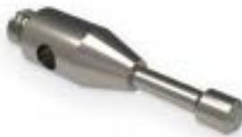
Zylindertaster werden zum Antasten dünnwandiger Bleche und scharfer Kanten verwendet. Sie werden dort eingesetzt, wo ein genaues Antasten mit einer Kugel nicht möglich ist. Die Stirnfläche des Antastelementes ist bei diesem Typ plan geschliffen.
