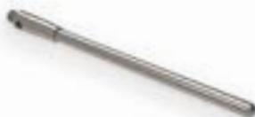
Zylindertaster werden zum Antasten dünnwandiger Bleche und scharfer Kanten verwendet. Sie werden dort eingesetzt, wo ein genaues Antasten mit einer Kugel nicht möglich ist. Die Stirnfläche des Antastelementes ist kugelförmig und wird zum axialen Antasten verwendet. Der Schaft ist durchgehend zylindrisch ohne Abstufung.
