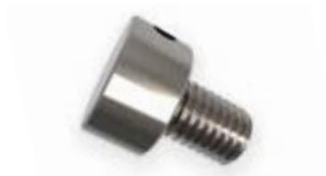
Gewindemessstifte werden zur indirekten Messung von Gewindebohrungen und -abständen verwendet.
