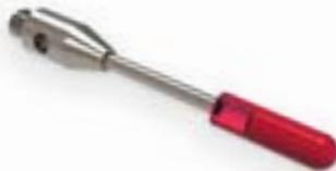
Zylindertaster werden zum Antasten dünnwandiger Bleche und scharfer Kanten verwendet. Sie werden dort eingesetzt, wo ein genaues Antasten mit einer Kugel nicht möglich ist. Die Stirnfläche des Antastelementes ist kugelförmig und wird zum axialen Antasten verwendet.
