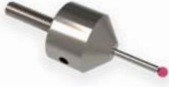
Ein gerader Taster mit einem langen (12,5mm) Gewinde M5. Die Schaftform ist durchgehend zylindrisch und kann aus folgenden Werkstoffen gefertigt werden: nicht rostendem Stahl, Hartmetall, Keramik oder CFK. Diese Taster bestehen meistens aus drei Komponenten: Halter, Schaft und Kugel. In wenigen Fällen werden Halter und Schaft monolithisch aus nicht rostendem Stahl gefertigt. Die Kugelwerkstoffe können Sie aus unserer Werkstoffübersicht entnehmen.
