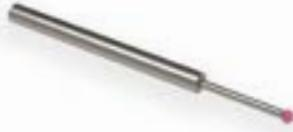
Taststifte bestehen aus einem Schaft und einer Kugel und haben kein Gewinde. Für den Einsatz dieser Taststifte sind entsprechende Klemmhalter erforderlich. Vorteil: schnelles Umrüsten möglich; preiswert und flexibel. Diese Ausführung hat einen abgesetzten Schaft.
