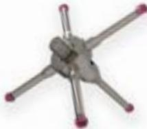
Die Sternntaster vom Typ V haben einen Gewindeanschluss und können direkt montiert werden. Sie haben in der Regel zwei bis vier Tastarme in radialer Richtung und einen in axialer Richtung. Die axial ausgerichteten Tastarme werden je nach Konfiguration zum Klemmen des rotierenden Sterns verwendet.
