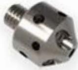
Klemmhalter ermöglichen den Einsatz von gewindelosen Taststiften. Sie sind sowohl mit axialen und mit radialen Bohrungen erhältlich.
