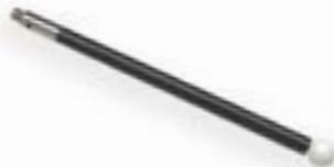
Ein gerader Taster in der einfachsten Form. Die Schaft- und Haltergeometrie sind durchgehend zylindrisch und haben den gleichen Durchmesser. Die Halter können monolithisch aus nicht rostendem Stahl gefertigt werden oder einen Schaft aus Kohlefaser haben. Die Kugelwerkstoffe können Sie aus unserer Werkstoffübersicht entnehmen.
