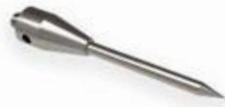
Tastspitzen sind eine Sonderform von geraden Tastern, bei denen der Kugelradius gegen Null geht. Beim Antasten ist zu beachten, dass Oberflächen sehr leicht durch die Spitze beschädigt werden können und im Gegenzug die Spitze selbst sehr empfindlich für Abnutzung oder Beschädigung ist. Der Haupteinsatz liegt bei sehr kleinen Antastflächen oder beim selbstzentrierendem Antasten von Bohrungen.
