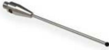
Ein gerader Taststift in seiner einfachsten Form. Der Schaft ist durchgehend zylindrisch und kann aus nichtrostendem Stahl, Hartmetall, Keramik oder CFK gefertigt sein. Diese Taster setzen sich in der Regel aus drei Komponenten zusammen: Halter, Schaft und Kugel. In wenigen Fällen werden Halter und Schaft monolithisch aus nichtrostendem Stahl gefertigt. Die Kugelwerkstoffe entnehmen Sie der Werkstoffübersicht.
