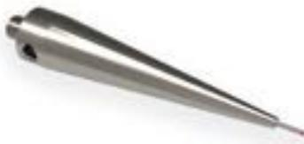
Feintaster mit konischem Halter ermöglichen die Kombination von kleinen Kugeldurchmessern, großer Gesamtlänge und maximaler Steifigkeit. Diese Taster bestehen aus drei Teilen: Halter, Schaft und Kugel.
