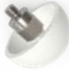
Hohlhalbkugeltaster eignen sich zur Messung von jenen Messelementen, die einen großen Durchmesser der Tastkugel erfordern, bzw. eine reduzierte Bauhöhe. Im Gegensatz zu Scheibentaster, die nur radiale Antastungen zulassen, können mit Hohlhalbkugeln auch stirnseitige Messungen erfolgen. Als Antastbereich ist die gesamte Hohlhalbkugeloberfläche erlaubt.
