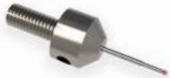
Ein gerader Taster mit einem einfach oder mehrfach abgestuften Schaft, der aus Hartmetall gefertigt wird. Das Gewinde M5 ist 12,5mm lang. Diese Taster bestehen aus drei Komponenten: Halter, Schaft und Kugel. Die Kugelwerkstoffe können Sie aus unserer Werkstoffübersicht entnehmen.
