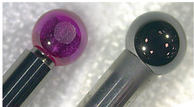
Optischer Vergleich zwischen den getesteten Tastern (links Rubin, rechts **UltraScanning**). Deutlich sichtbar: Die **UltraScanning** hat absolut keinen Auftrag.
